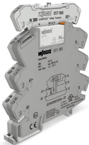
Um den Schaltstrom des DOs zu erhöhen, kann dieser durch ein Relais erweitert werden. Dank der Konturengleichheit von Serie 857 und 2857 kann beispielsweise ein Relais (857-359) danebengerastet werden. Durch einfaches Brücken mit einem Querbrücker (859-402) ist dieser Ausgang schnell und einfach auf einen Schaltstrom von 6 A erweitert.
